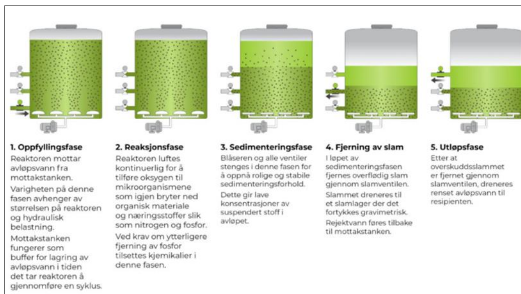
Figur 23. Forskjellige faser av en SBR prosess basert på aktivslam (kilde: Biovac®)
